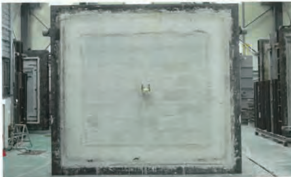
사진 4. 내화시험 후 시험체 가열면
