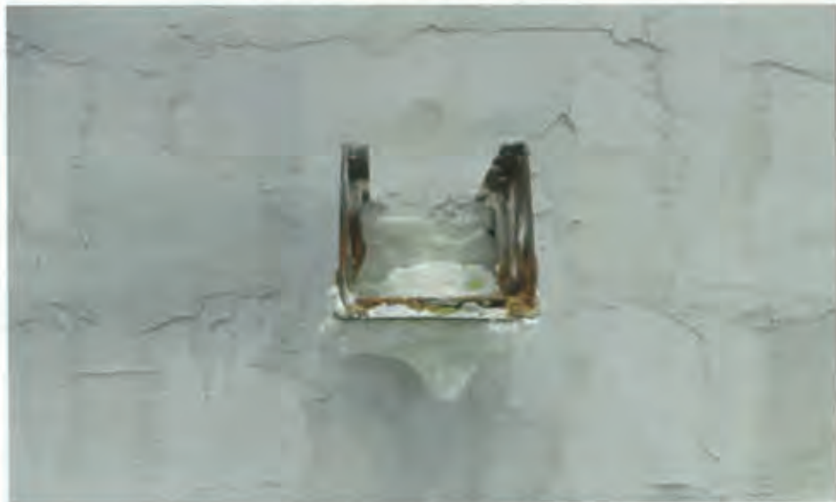
사진 8. 내화시험 후 시험품 형상
