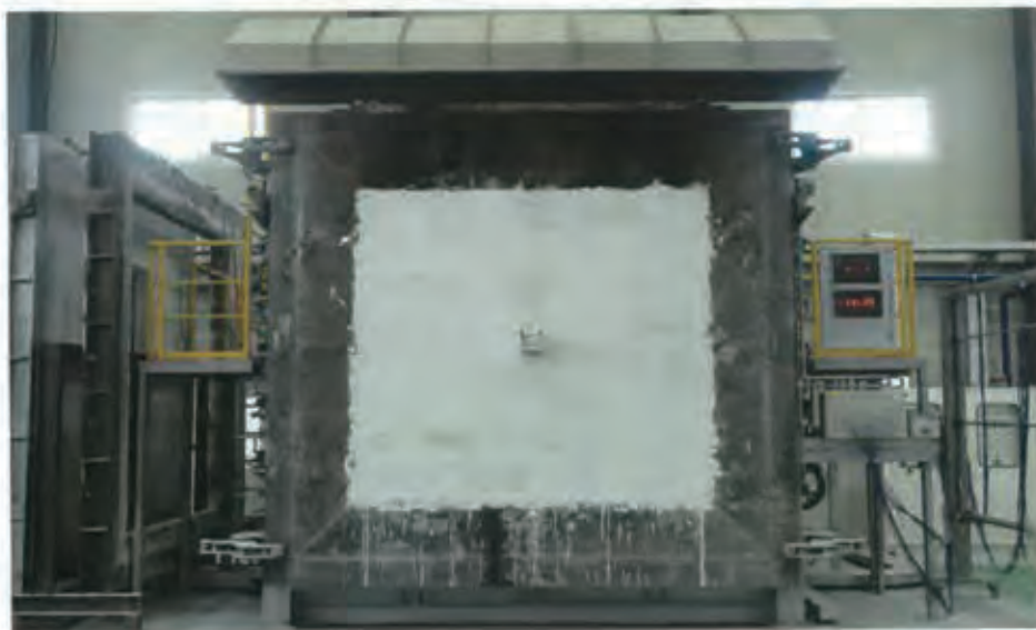
사진 6. 내화시험 후 시험체 비가열면
